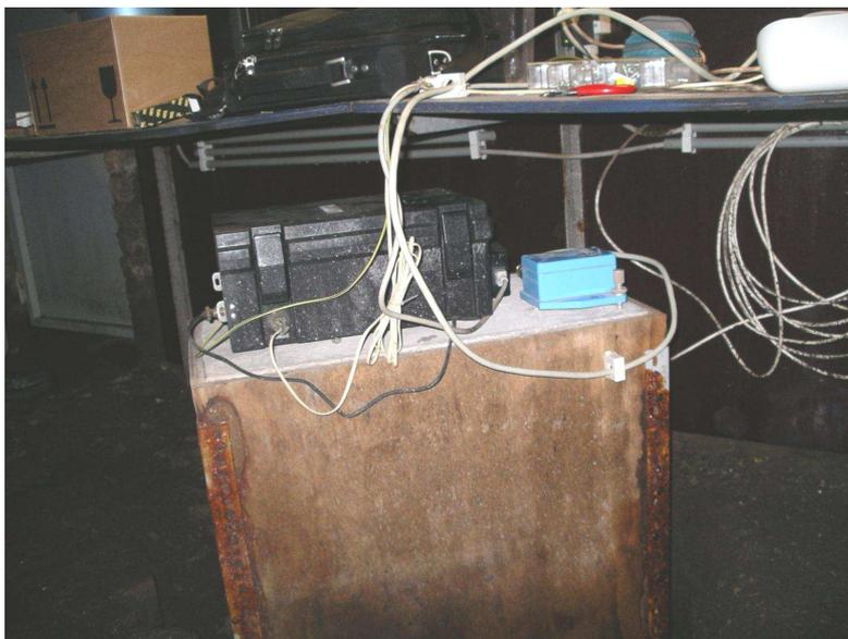
FIGURE 5.2 – Pilier avec le sismomètre et l'accéléromètre à la station de La Chartreuse (LCH) à Liège
