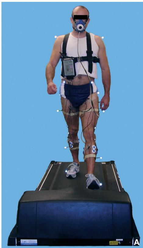
**Figure 14.** Exemple de la mesure de la consommation énergétique sur tapis roulant. L'appareillage qui mesure la quantité d'air expiré de même que la teneur en  $O_2$  et  $CO_2$  dans cet air est placé à côté du sujet (photo réalisée au laboratoire de C. Detrembleur).
